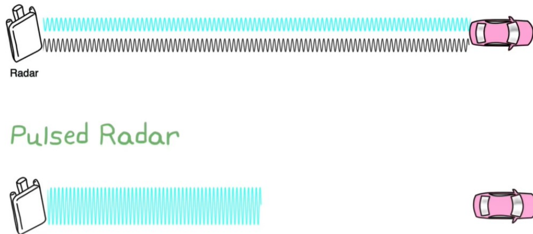
Hình 3.32 Mô tả hình ảnh sóng liên tục (phía trên) và sóng radar dạng xung (phía dưới) (Nguồn: Matlab)
